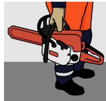
Rys. 1. Prawidłowy sposób pracy z pilarką łańcuchową – transport
